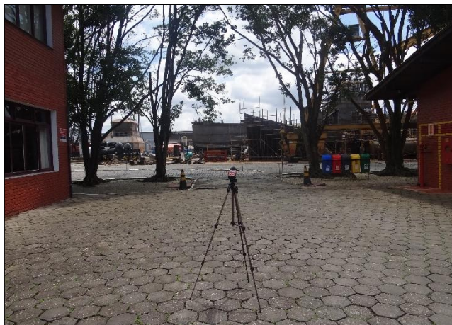
Figura 3.16. Posicionamento de equipamentos (sonômetro com microfone acoplado) durante uma medição dos níveis de pressão sonora.
