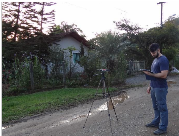
Figura 3.17. Acompanhamento do supervisor responsável durante uma medição dos níveis de pressão sonora.
